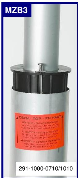
Bodenhülsen sind in den Rohrstückversionen MZB1 (Kunststoff) und MZB2 (Aluminium) günstig zu bekommen. Wir empfehlen aber die **Bodenhülse MZB3**. Zwischen Mast und Hülse sitzt hier ein Kunststoff-Zentrierkeil. So klappert der Mast nicht in der Hülse, fällt kein Dreck dazwischen und gammelt nicht Metall an Metall. Der Mast sitzt auch fester. Falls Sie den Fahnenmast mal entnehmen möchten, können Sie optional eine nicht überfahrbare Abdeckkappe bekommen.
